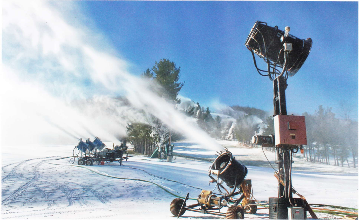
▲ Снежные пушки компенсируют недостаток расстояния до земли мощностью воздушного потока
